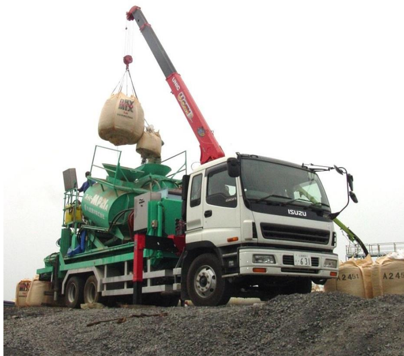
東京モノレール支柱補強工事のため台船に 下ろすため吊上げられたスーパーMP21A
