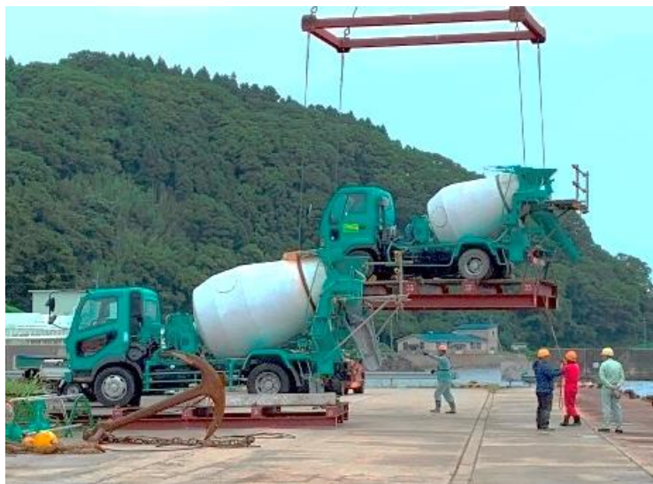
釜谷漁港機能保全工事 スーパーMP21-TM8T スーパーMP21-TM3 台船に積み込むために吊り上げられた スーパーMP21-TM3
