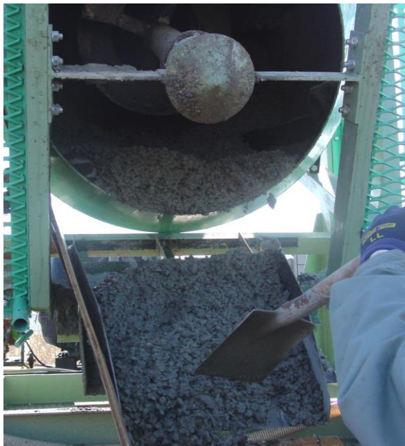
コンクリート排出中
